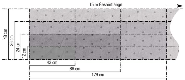
Dank der mehrfachen Längs- und Querperforation kann für jeden Anwendungsfall das passende Format leicht abgerissen werden.
