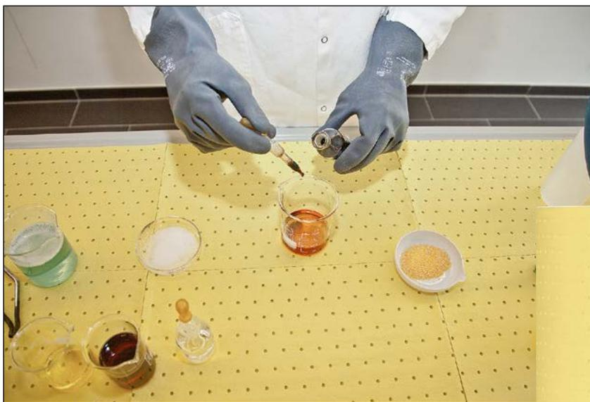
Besonders strapazierfähige und fussellose Chemikalien-Bindevliesrollen mit höchster Reiss- und Abriebfestigkeit für einen langfristigen Einsatz, z.B. zum Schutz von Böden, Breite 38 oder 76 cm
