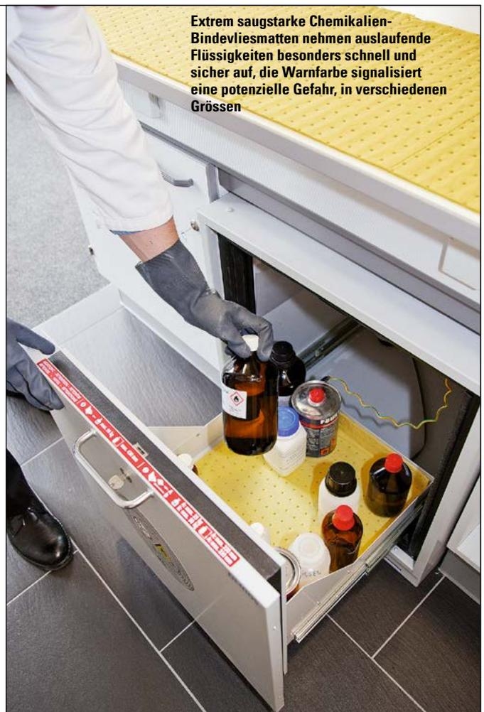
Extrem saugstarke Chemikalien- Bindevliesmatten nehmen auslaufende Flüssigkeiten besonders schnell und sicher auf, die Warnfarbe signalisiert eine potenzielle Gefahr, in verschiedenen Größen
