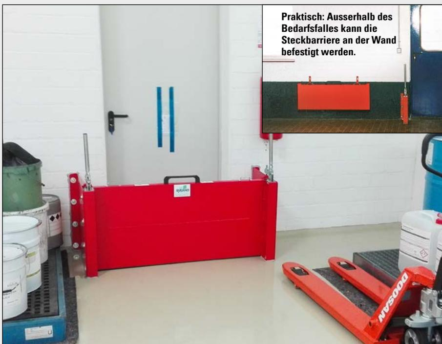
Praktisch: Ausserhalb des Bedarfsfalles kann die Steckbarriere an der Wand befestigt werden.
